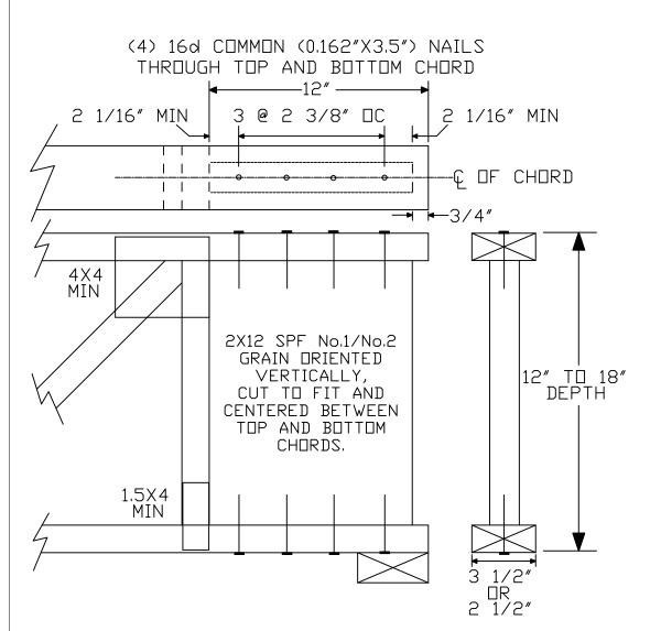
THIS TRUSS DETAIL APPLIES TO 4X2 AND 3X2 TRUSSES ONLY.
