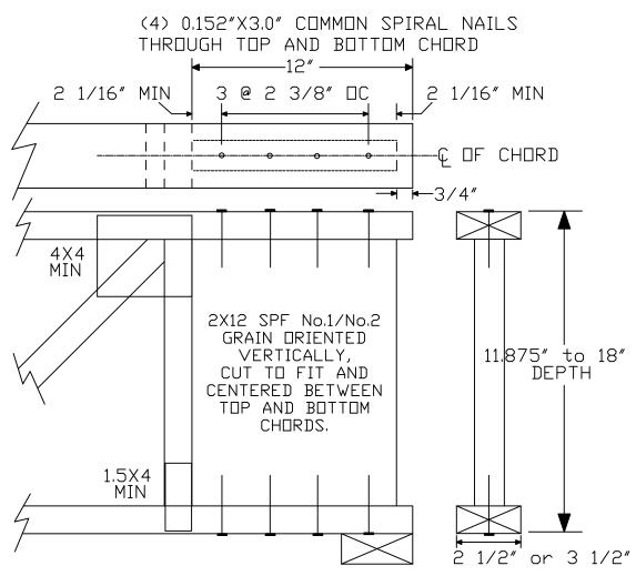
THIS TRUSS DETAIL APPLIES TO 4X2 AND 3X2 TRUSSES ONLY.
