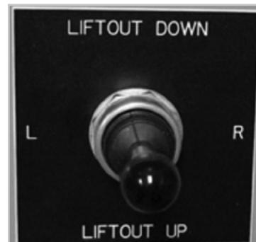
Figure 58 Lorsque les plaques sont partiellement incrustées dans le treillis par le portique, utiliser le relevage pour déplacer le treillis vers le rouleau du convoyeur qui l'enverra vers la presse de finition pour complètement incruster les plaques.
