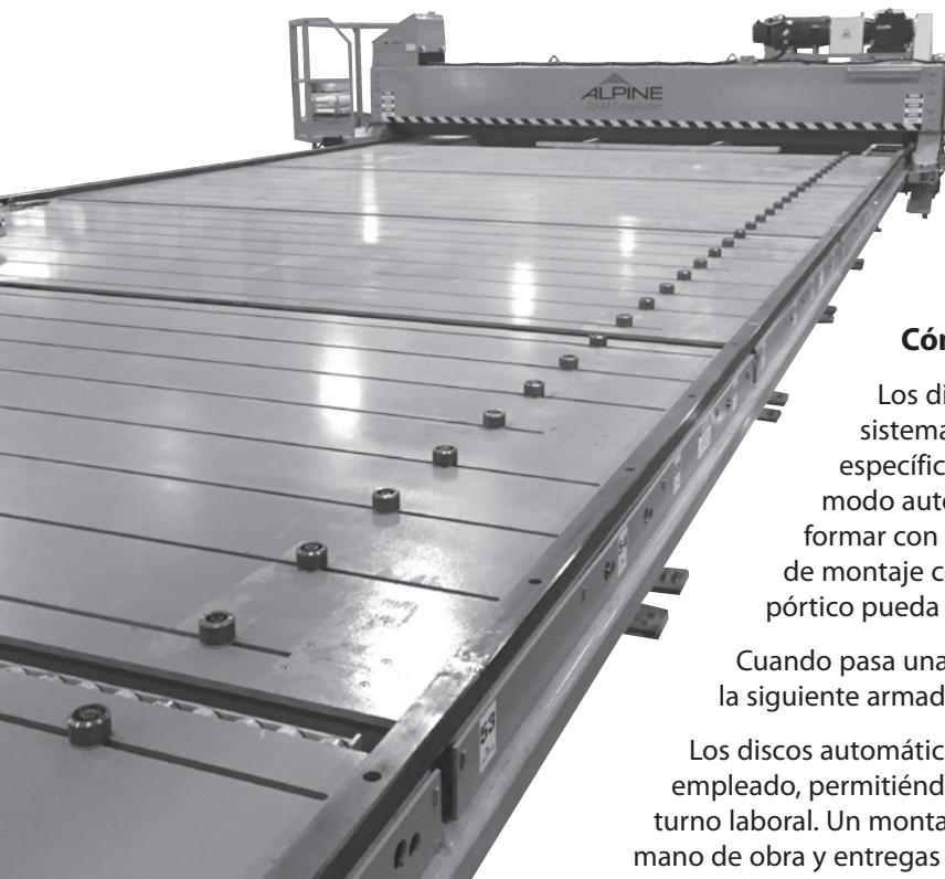
El sistema de plantillas **Alpine AutoSet Plus** controlado por computadora es una opción que funciona con *Alpine RAM EasyRider*, *Alpine RollerPress* y *Alpine SmartView* para conformar un sistema completo de fabricación de armaduras de cubierta altamente automático.
